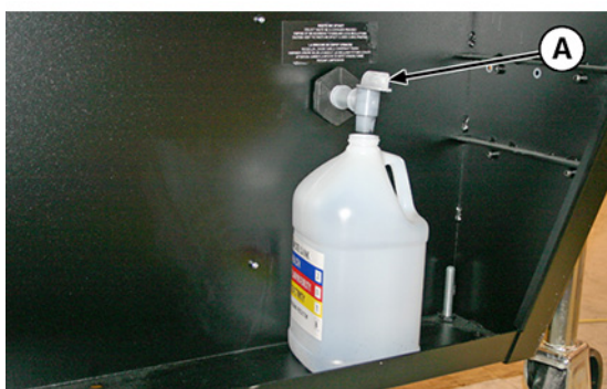
Figure 10-24 Bouteille d'encre usagée et robinet d'évacuation
