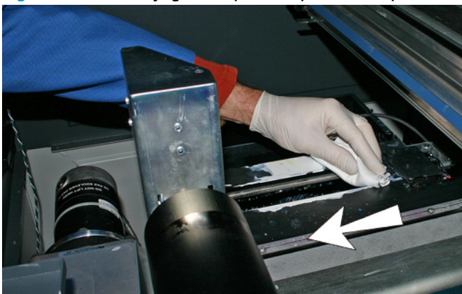
Figure 10-10 Nettoyage de la partie supérieure du poste de service
