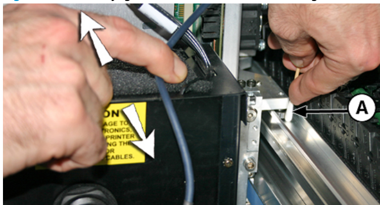
Figure 10-15 Nettoyage des roues de chariot avec une tige de coton ouaté
