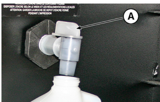
Figure 10-25 Robinet d'évacuation de l'encre usagée en position fermée
