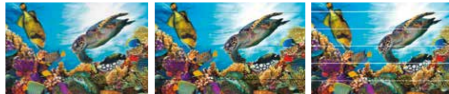
Posizione del punto errata Sovrapposizione/striature nere (insufficiente velocità dei supporti) Intervallo/striature bianche (eccessiva velocità dei supporti) Con DAS Corretta impostazione di alimentazione supporti e posizione del punto
