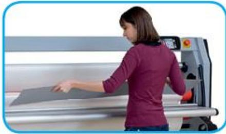
La machine est livrée avec une plaque d'introduction qui limitera les pertes de matières et permettra des gains de temps importants lors de la mise en place des films.
