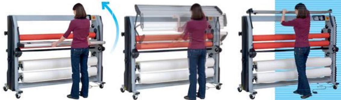
La table d'introduction pivote en position haute, autorisant un accès complet et sécurisé lors de la mise en place des bobines. Table levée, l'avance de la machine ne peut être déclenchée sécurisant ainsi l'opérateur durant cette période.
