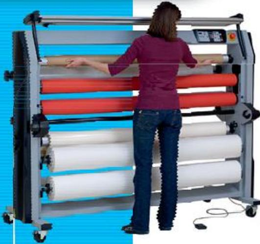
Nos nouveaux axes autobloquants, encore plus légers, vous font gagner du temps lors des changements de films car aucun outil n'est nécessaire contrairement à certains produits utilisant des cônes ou un système d'axes pivotants demandant un recul important.
